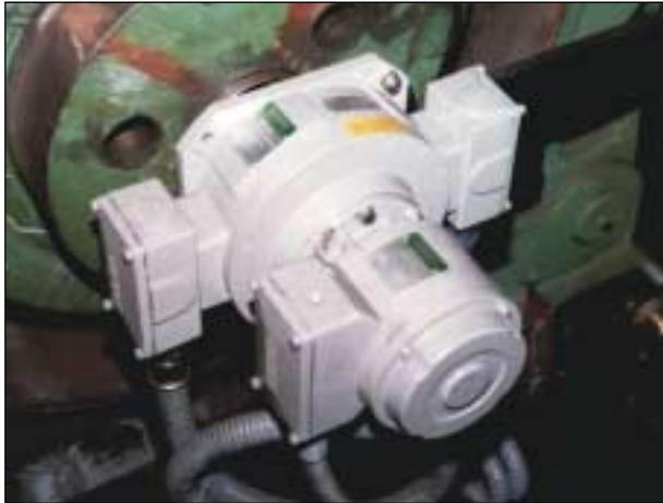
FGH 6-Hohlwelle – Ø 50 mm – aufgesteckt mit angekoppeltem FG 4 / AMI 4 / EGS-Geber
